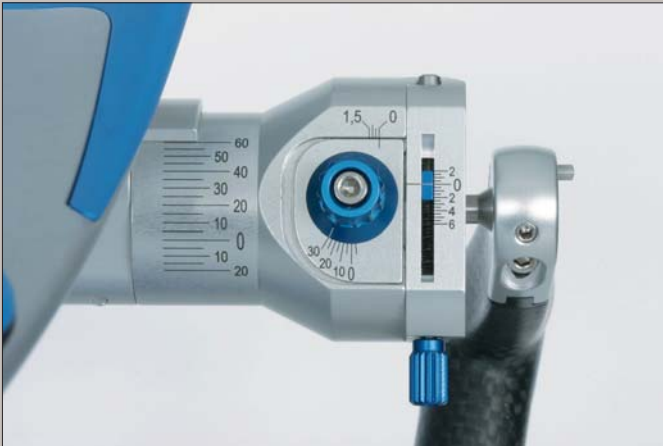
Przystawka C.A.R. do kompensacji bezwarunkowego odruchu wysunięcia żuchwy do przodu po założeniu jakiegokolwiek masy rejestrującej
