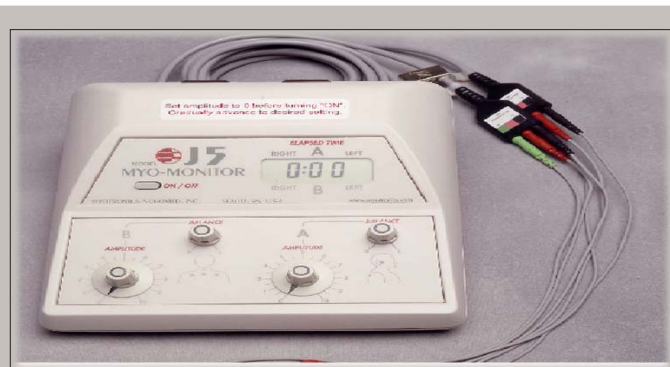
Aparat TENS do samodzielnego ustalenia zwarcia neuromięśniowego w celu wykonania aparatu okluzyjnego
